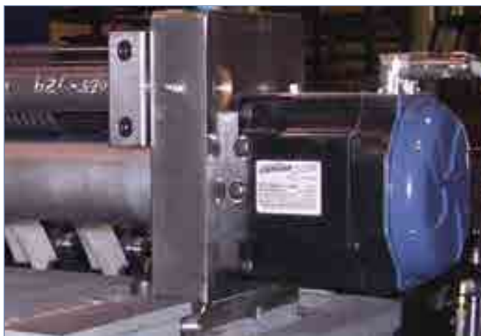
相同的机器，但是安装了一个模块化DDR电机。这里，从动辊的轴伸展到模块化DDR电机中，电机转矩直接加到从动辊上。
