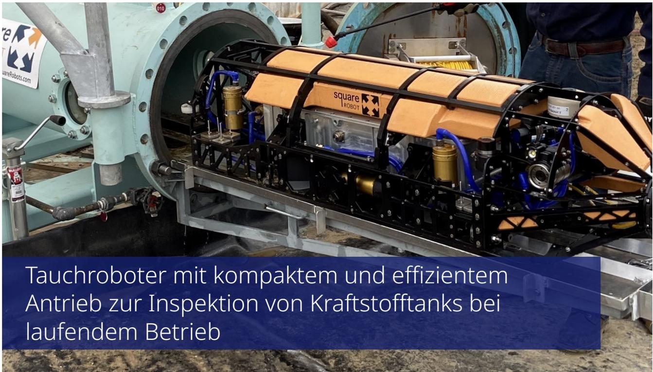
Das 2016 gegründete Unternehmen Square Robot bietet innovative Roboter für die Inspektion von oberirdischen Tanks, in denen Diesel, Benzin, Kerosin, verschiedene Öle und andere Produkte gelagert werden. Durch die kontinuierliche Weiterentwicklung der Roboter-, Datenerfassungs- und Datenverarbeitungstechnologien ist Square Robot als einziger Anbieter in der Lage, Inspektionen zur Gewährleistung der Unversehrtheit und Sicherheit von Tankanlagen auch während des laufenden Betriebs durchzuführen.
