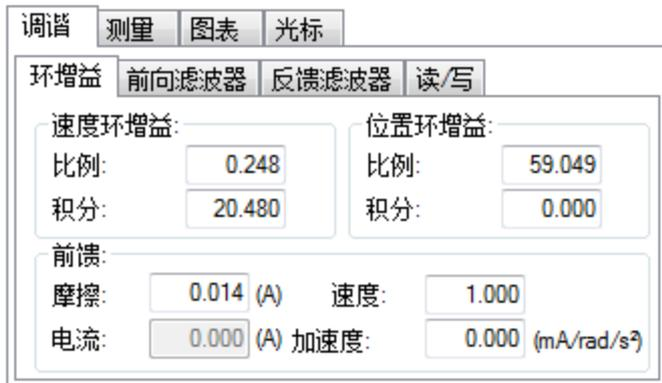
这种调谐界面在每次测量时会将调谐参数加载到驱动器上。调谐参数分为环增益(速度环、位置环)、正向通路双二阶滤波器和反馈通路双二阶滤波器。
