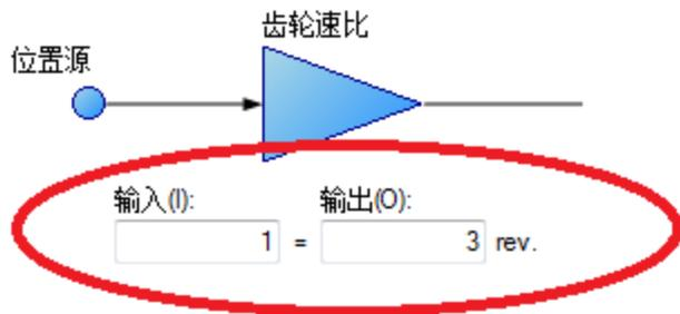
位置命令 (DRV.HANDWHEEL) 可读取 EEO 值, 其中 4,294,967,296 是指输入一整圈, 然后即可推算出相应的值。齿轮速比不影响 EEO 值。如果输出设置为每输入 1 圈输出 3 圈, 那么电机每转 3 圈就会有 4,294,967,296 的计数。
