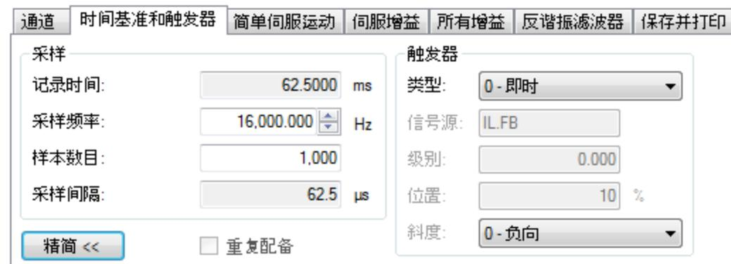
在此视图的**采样**区域中，可以指定记录长度，为此请输入采样频率和样本数目。此处显示的记录时间是一个仅供参考的计算值。
