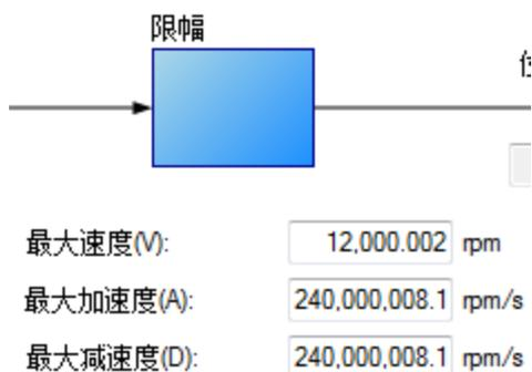
只有在齿轮传动模式下, 而且各装置的输出电机速度及加速度都一致时, 才会应用这些限幅 (GEAR.ACCMAX、GEAR.DECMAX、GEAR.VELMAX)。驱动器中的其他所有限幅都随齿轮传动限幅一起激活。
