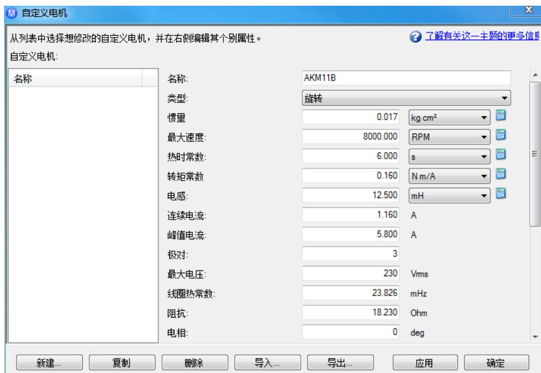
在此视图中，您可导入或导出一份电机参数文件，或者创建您选择的自定义电机。必须从列表中选择适合的参数。多种参数允许您选择一种测量换算单位。当创建自定义电机文件时，请勿在您选择的名称中使用空格。一旦您配置一台或多台自定义电机，如果您从列表中选择一台自定义电机并单击“确定”，则选择的自定义电机将在**选择电机**屏幕上显示。
