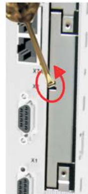
5 - Break the bottom rib
